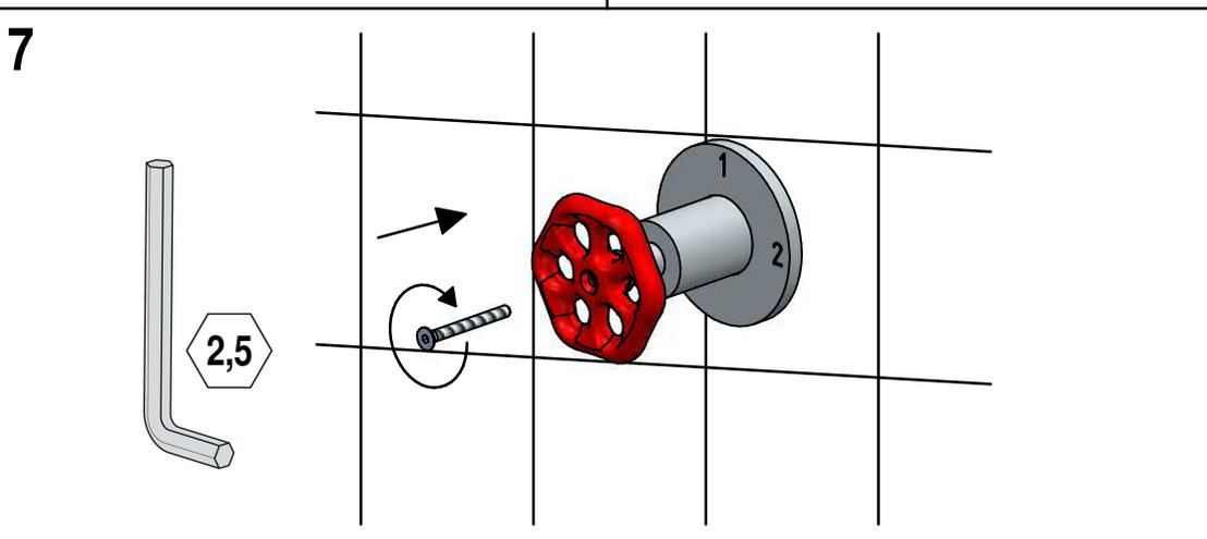
**! SOSTITUZIONE DEVIATORE / DIVERTER REPLACEMENT**
